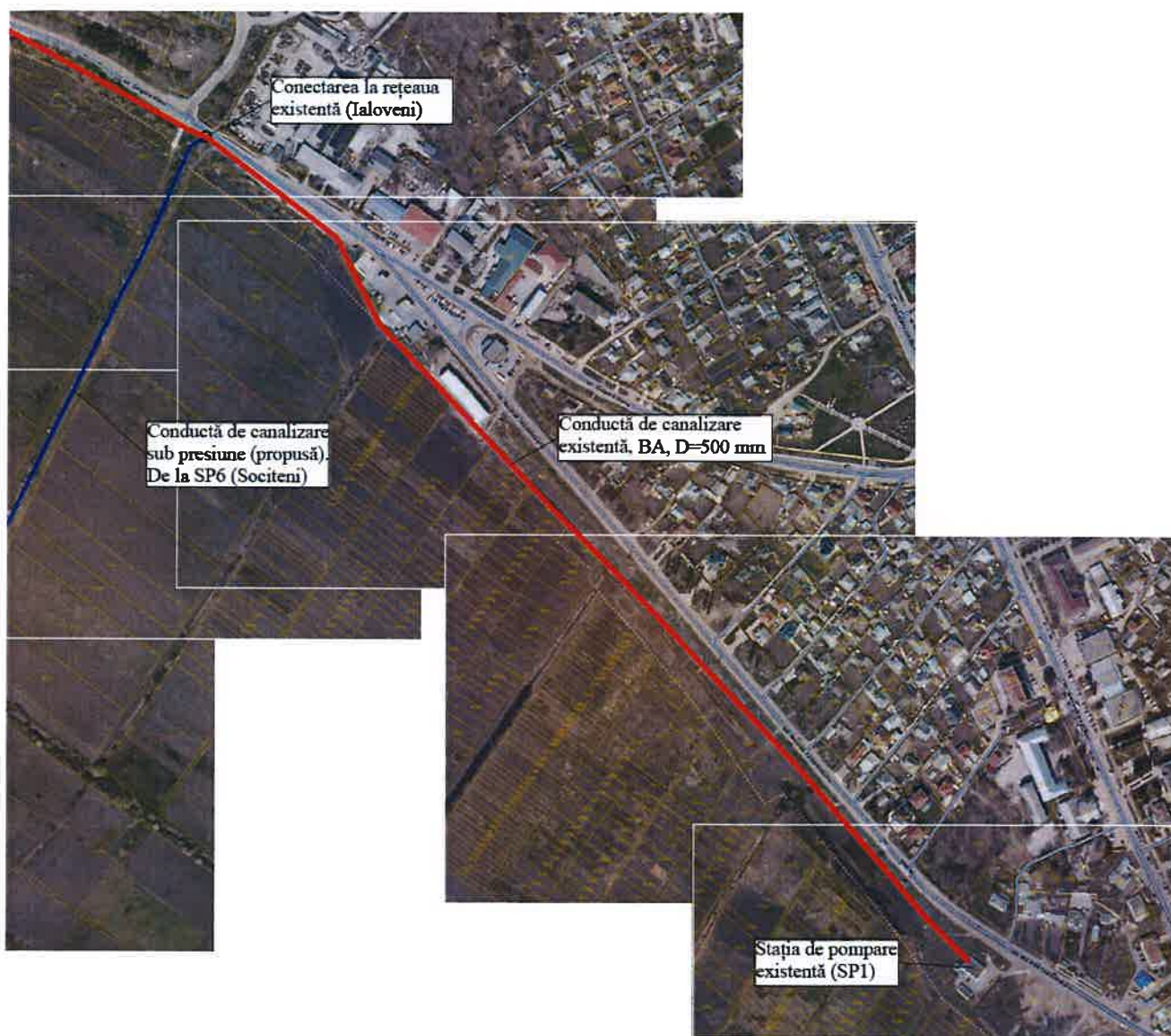
Figura 3-4. Sectorul conductei de canalizare de la posibilul punct de conectare până la stația de pompare existentă
